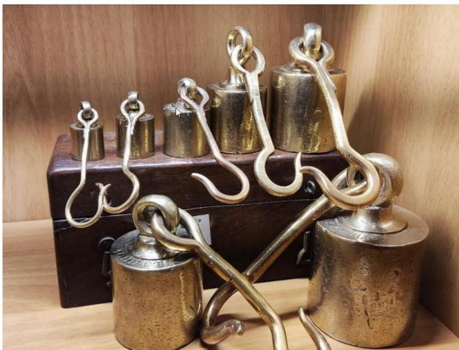
Serie di undici pesi in ottone di forma cilindrica con anello e gancio ad uncino per la sospensione. Masse di 10 kg (3), 5 kg, 2 kg (2), 1 kg, 500, 200, 100 e 50 g. Sotto ad ogni peso cavità per la massa di correzione chiusa da una vite in ottone.
