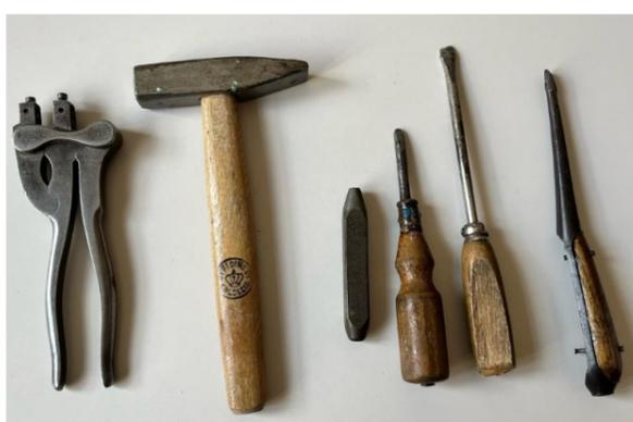
Pinza e punzone servivano per marchiare gli strumenti una volta effettuata la verifica con esito positivo.
