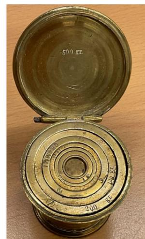
Pila di pesi chilogrammo a bicchiere in custodia detta casa, dotata di coperchio con una cerniera. La casa contiene 12 pesi totali e in totale pesa come la somma di tutti gli altri pesi. Era dotata o di un fermaglio che si andava ad inserire in un piccolo perno fissato sul corpo della casa stessa oppure di una custodia in pelle con fibbia. Modalità d'uso: porre il peso sulla bilancia o strumento di pesatura desiderato calcolando la massa sconosciuta dell'oggetto sotto verifica
