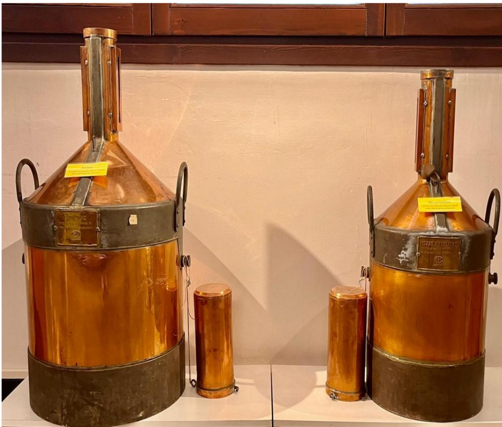
Utilizzata dall'ispettore sul campo per la verifica e le ispezioni su liquidi diversi dall'acqua (es. carburanti). Il metodo di verifica si chiama metodo "Volumetrico" per confronto con campioni di lavoro.
