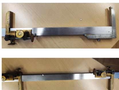
Cursori in ottone dotati di incavo quadrangolare utile all'inserimento del metro e triplometro campione. Viti di bloccaggio terminanti con testa ellittica e piatta, in posizione ortogonale l'una rispetto all'altra. Serviva per controllare anche misure di dimensione
