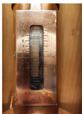
Utilizzata dall'ispettore sul campo per la verifica e le ispezioni su liquidi diversi dall'acqua (es. carburanti). Il metodo di verifica si chiama metodo "Volumetrico" per confronto con campioni di lavoro.
