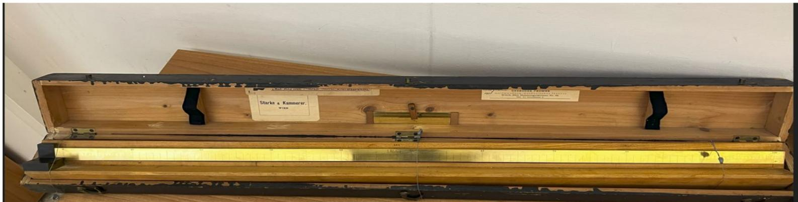
Si tratta di un metro campione in ottone contenuto in una scatola di legno. La scala di questo campione è millimetrica per i primi dieci centimetri, poi è centimetrica. Le lunghezze sono riportate per ogni centimetro per il primo decimetro; poi solamente ogni cinque centimetri. Sono pure segnati, con le cifre dall'uno al dieci, i diversi decimetri. Sopra la scala vi è scritto "Metro"
