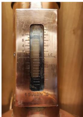
Utilizzata dall'ispettore sul campo per la verifica e le ispezioni su liquidi diversi dall'acqua (es. carburanti). Il metodo di verifica si chiama metodo "Volumetrico" per confronto con campioni di lavoro.
