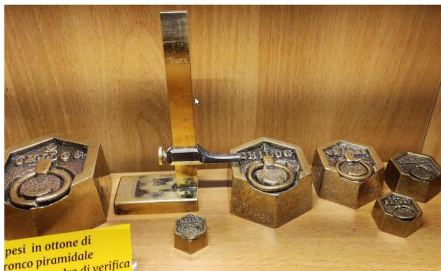
Nella faccia inferiore è presente una piccola cavità per la massa di correzione di forma circolare entro la quale è inserito piombo a scaglie o fuso per aggiustaggio. Masse di 50, 100, 200 e 500 g. , 1 e 2 kg.
