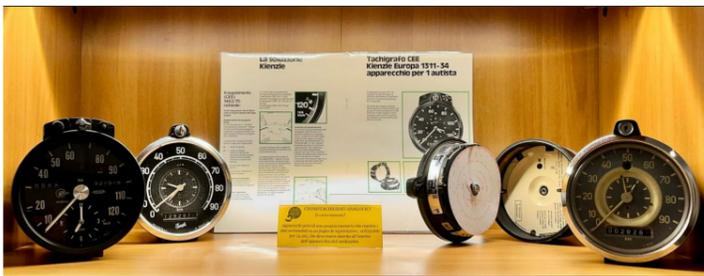
Il tachigrafo è lo strumento che registra la velocità ed i tempi di guida dei conducenti di camion, pullman ed autocarri
